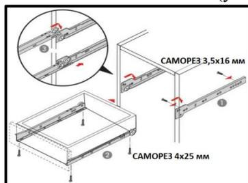
Рис. 2 Установка направляющих (установка на саморезы 3,5x16 мм и 4x25 мм)
