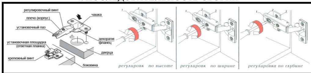
Рис. 1 Установка петель (установка на саморезы 4x16 мм)
