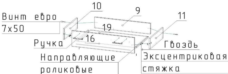
1. Соедините детали 9, 10, 11 с помощью винтов евро 7x50 мм.
